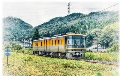
▲キヤ141系の小浜線検測時の写真。クモヤ443は、架線等の電気関係を検査するが、こちらは線路や建築限界などを検査する。車両は気動車である。
